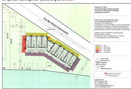
Einstufung der Gebäudefassade in die Lärmpegelbereiche (LPB) nach DIN 4109 – unter Berücksichtigung des Immissionsbeitrages Schiene zur Nachtzeit
